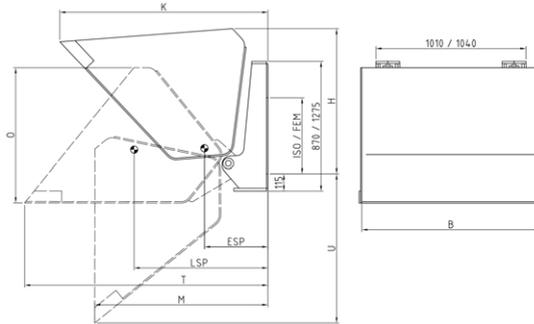
2 Zylinder Landhandelschaufel – Schüttgewicht 2500 kg/m<sup>3</sup>, Rückenteil Bauhöhe 870 mm, Baubreite 1010 mm
